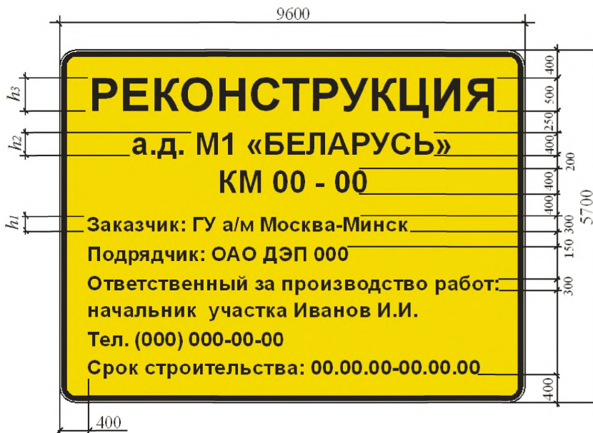
Рисунок В.1 – Пример компоновки информационного щита (размеры даны в миллиметрах)
